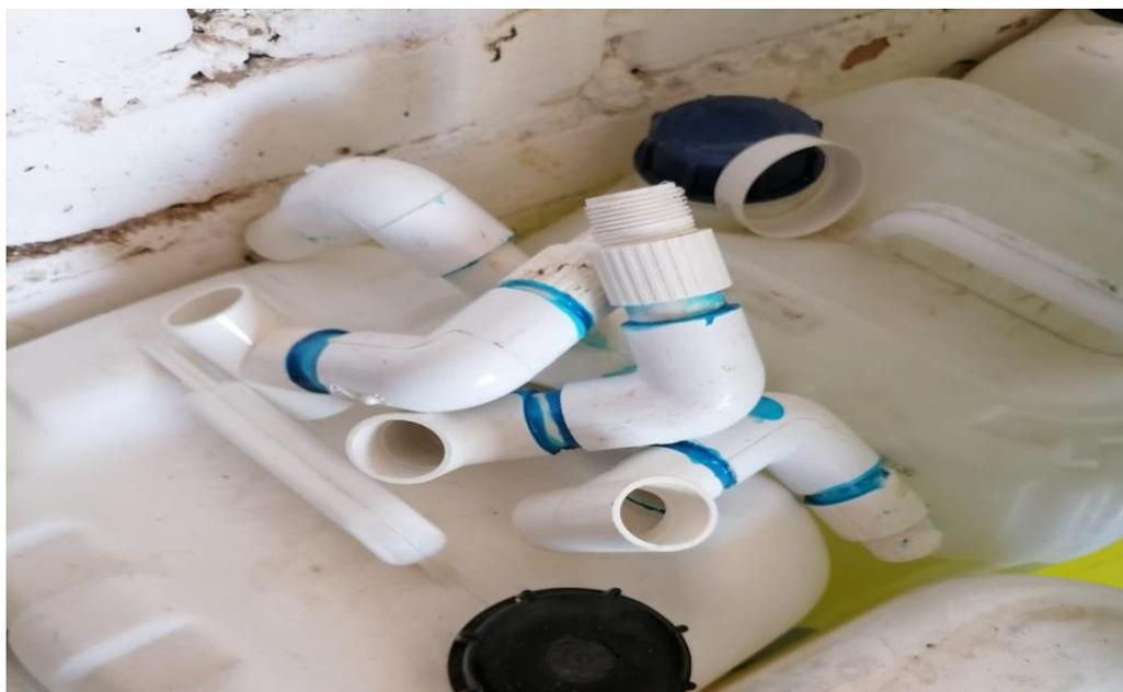
*Ilustración 7 Tipos de codos PVC Fuente: propia*
